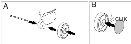
Para montagem das rodas (Fig. A e B), insira os pinos de aço da parte interna da carenagem à parte externa. Em seguida, introduza as rodas no eixo, com a parte lisa da roda em contato com a carenagem. Trave as rodas utilizando a arruela, porca e parafusos. Por fim, fixe as calotas na parte externa das rodas, encaixando as quatro travas centrais até ouvir o click.
