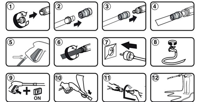
1 - Rosqueie a conexão 3/4" na entrada de água. (Fig 1)
